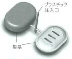
射出成形による石鹸ケースの製作例
